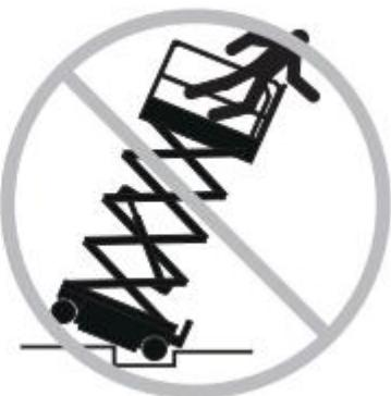
在收起状态下，当机器在不平坦的地帶、有碎石、不稳定或光滑的表面、靠近洞口和陡坡等处行驶时，要小心并降低速度。
