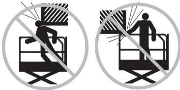
当抓住平台防护栏时，当心有挤压的危险，应注意观察和使用平台控制手柄及底盘控制器上的执行行驶、升降和转向功能的色标方向箭头。
