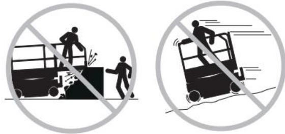
根据地面状况、拥挤程度、坡度、人员位置和可能引起碰撞的任何其它因素，限制行驶速度。
