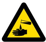
电池中含有酸性物质，应防止其泄漏，并避免与之接触。如果电池中的酸性物质泄露，用苏打水和泄漏的酸性物质。
