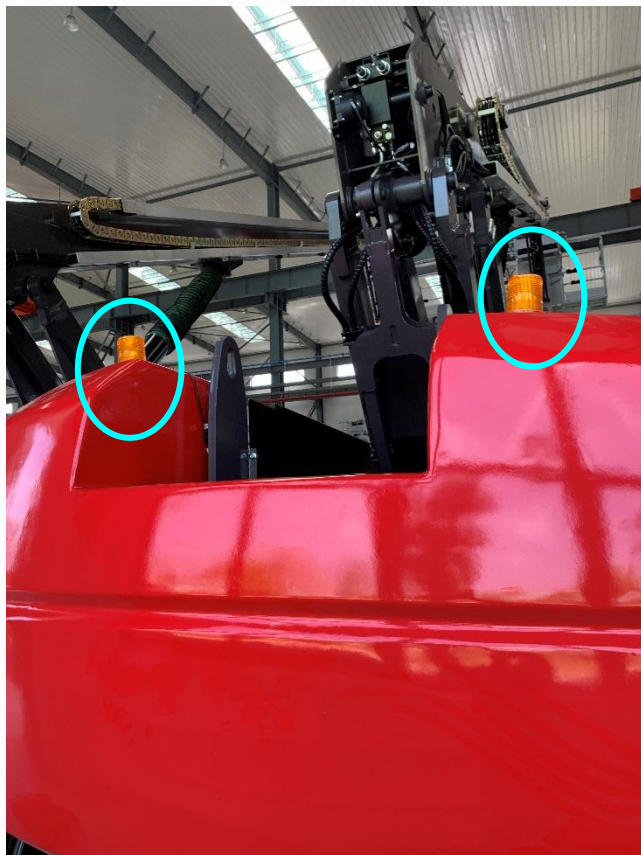
Warning lamp Location / 警示灯位置
