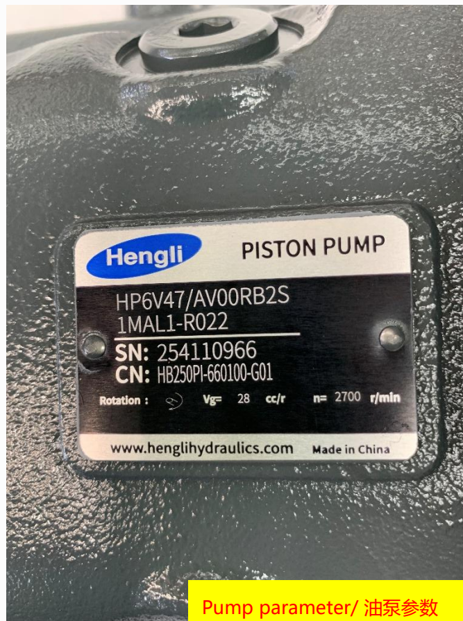
Main pump / 主油泵
